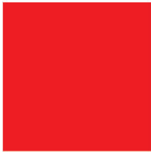
图 3.1.2-1 大轮通航桥孔和大小轮共用 通航桥孔桥涵标
